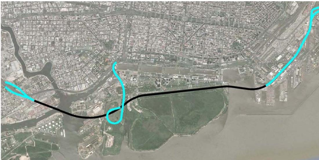
Se vincula con la Autopista 25 de Mayo mediante un viaducto sobre construcciones existentes para luego empalmar con la autopista en túnel mediante un distribuidor tipo trompeta. Este distribuidor se ubica sobre terrenos de la ex Ciudad Deportiva de Boca.
