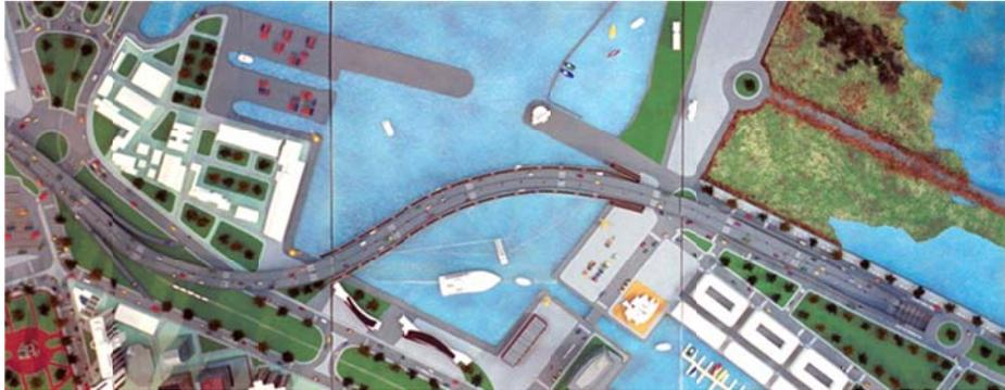
En el sector sur se ubica sobre una franja de terreno aladaña a la calle Brasil. La conexión de este nuevo alineamiento con el existente, se resuelve a través de un distribuidor tipo trompeta, el cual se desarrolla casi íntegramente dentro del predio que hoy está ocupado por un obrador y depósito de elementos, encontrándose actualmente libre de mejoras. Afecta a un edificio existente.
