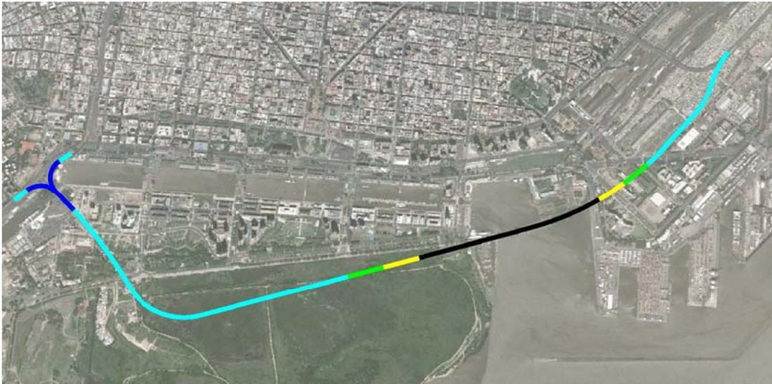
La orientación del eje se mantiene empalmando con el trazado original frente a la Estación Terminal de Ómnibus, luego de sobrepasar la Avenida Antártida Argentina. Las pendientes en este sector están entre 1,7% y 3%, con una longitud de pendiente de 1.700 metros aproximadamente.
