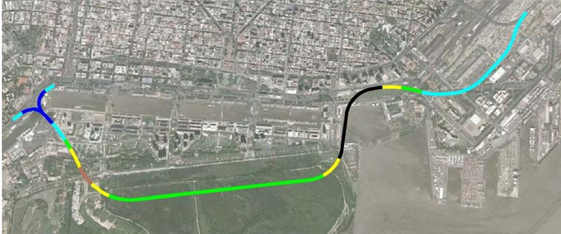
Se diseñó un distribuidor intermedio con conexión a la Costanera Sur. A llegar a la Av. Cecilia Grierson ingresa en túnel por debajo de Dársena Norte. En este punto se prevé una entrada y una salida hacia y desde el Sur. En la zona de Empalme Norte sale a nivel y se eleva en terraplén y luego en viaducto sobre Av. Antártida Argentina para empalmar con el Distribuidor Retiro, de acuerdo al diseño del viaducto original.
