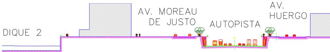
El primer tramo, de 3,5 km., se diseñó con tres (3) carriles por dirección. Se prevé un distribuidor con acceso al puerto y a la Av. Figueroa Alcorta, a través de ramas elevadas sobre las vías a la altura de la calle Junín. Este distribuidor se desarrolla sobre la actual Villa 31 y algunos depósitos y playas de contenedores.
